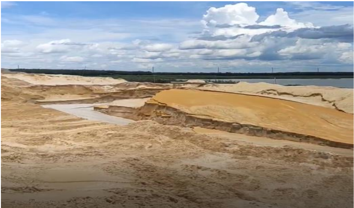
Hình 3.4. Mương thoát nước thải sản xuất
