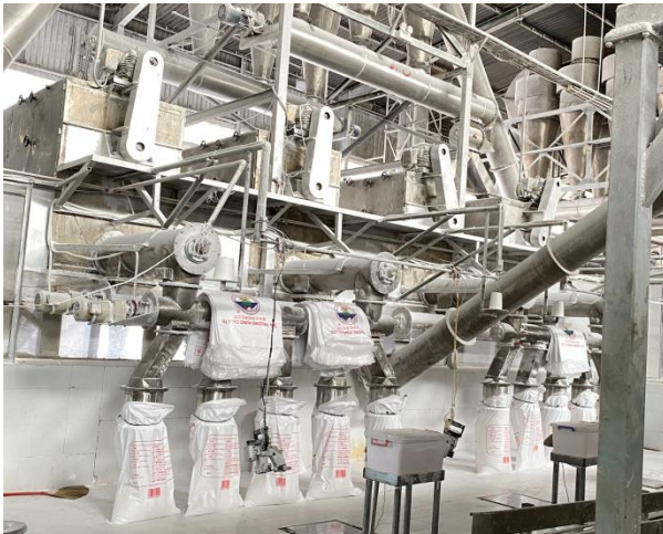
Hình 3.12. Thiết bị đóng bao có trang bị cân định lượng tự động
