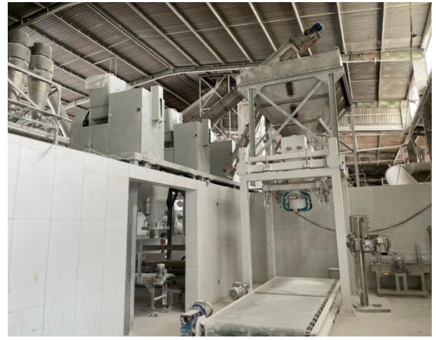
Hình 3.12. Thiết bị đóng bao có trang bị cân định lượng tự động
