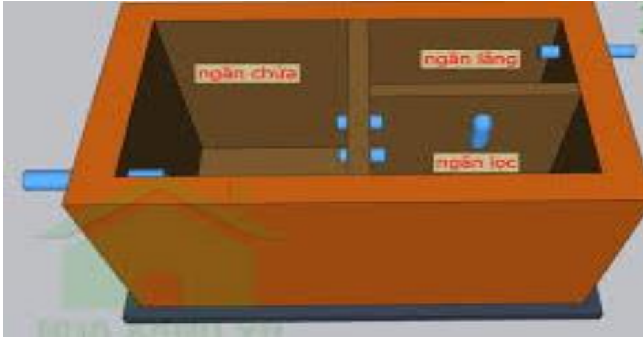
Hình 4.1. Cấu tạo bể tự hoại 3 ngăn
