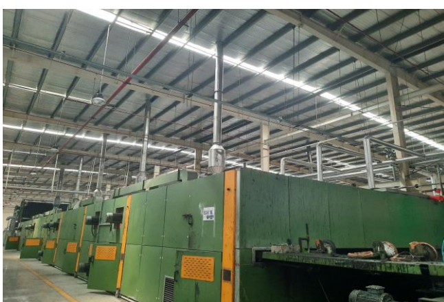
Hình 1. 20: Lên keo mặt sau thảm và sấy khô
