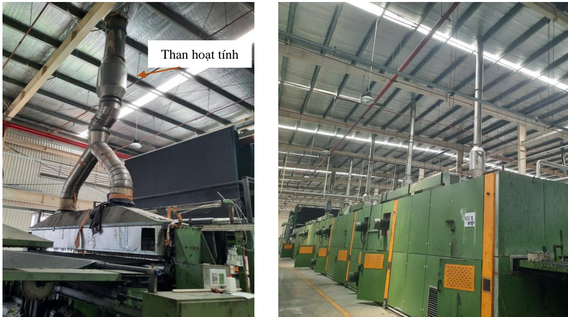
Hình 3. 13: Hệ thống xử lý hơi dung môi tại công đoạn lên keo và sấy khô thảm cỏ
