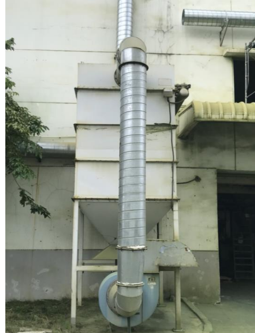
Hình 3. 18: Hệ thống xử lý bụi tại công đoạn pha bột màu
