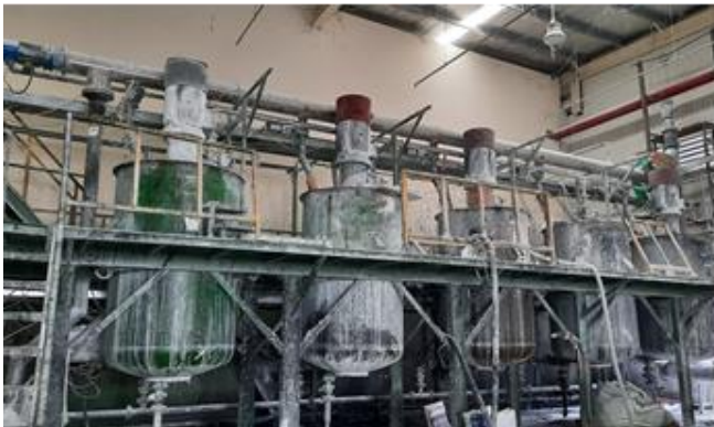
Hình 3. 15: Bồn pha keo và hệ thống xử lý hơi dung môi từ công đoạn pha keo
