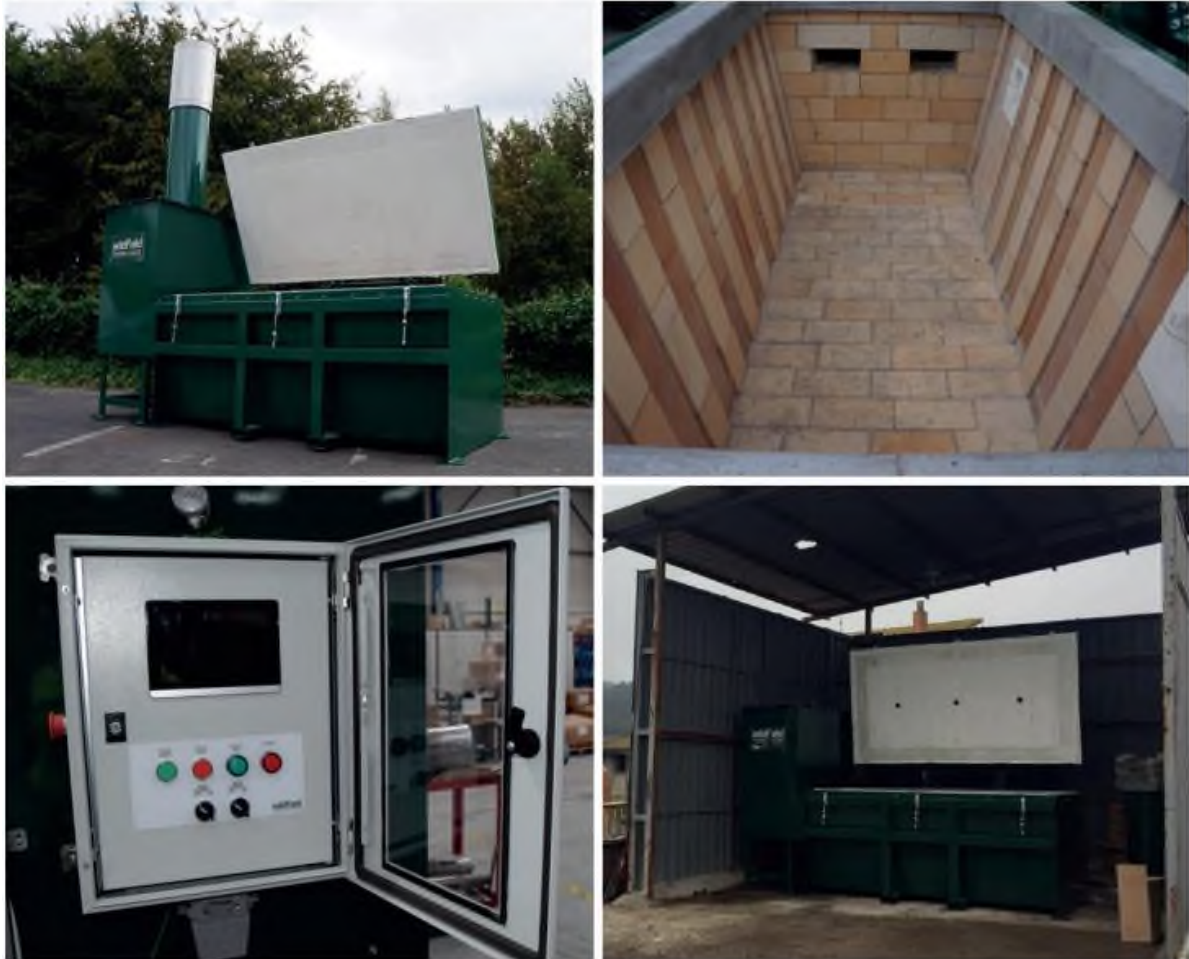
Hình 4.1: Hệ thống lò đốt xác heo
