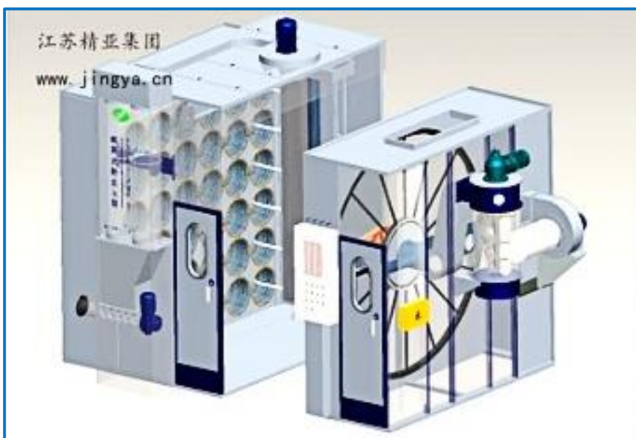
Hình 3.7 Ảnh minh họa bên trong công trình xử lý bụi cho máy chải thô đã lắp đặt
