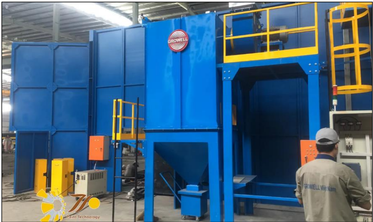
Hình 1.9: Hình ảnh tham khảo máy phun bi xử lý bề mặt kim loại
