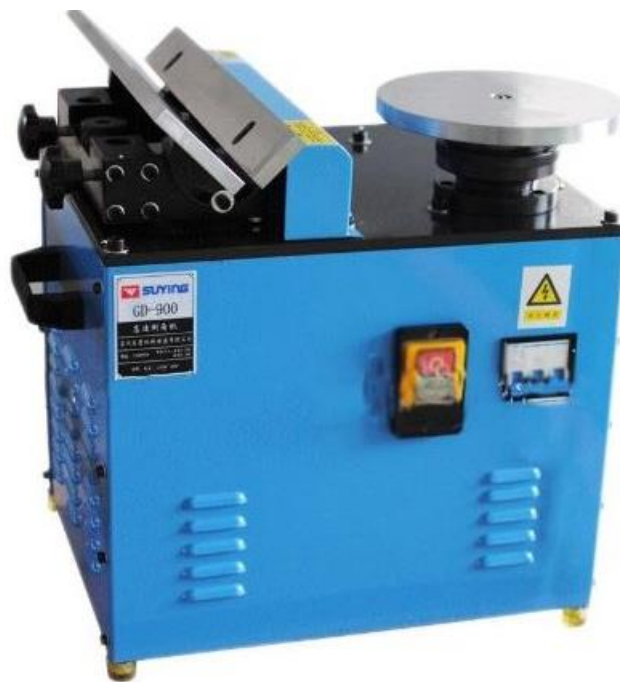
Hình 1.8: Hình ảnh tham khảo máy vát cạnh tại dự án
