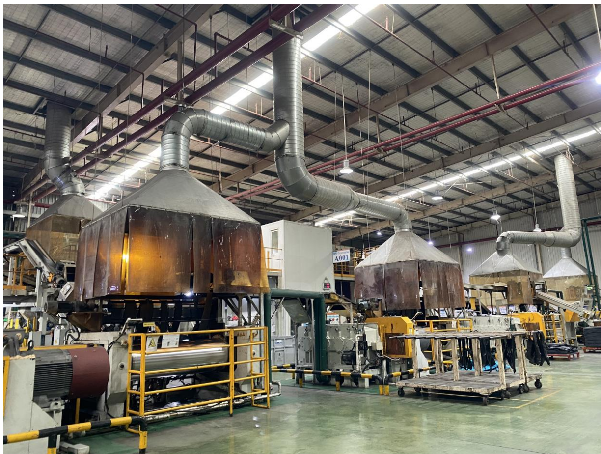
Hình 3.16 Hệ thống thu gom nhiệt nhừ từ dây chuyền máy cán tráng
