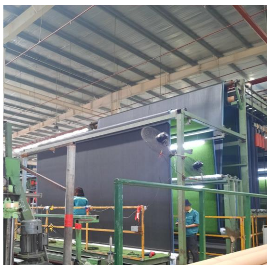
Hình 1. 22: Kiểm tra thảm cỏ sau khi lên keo, sấy và đục lỗ
