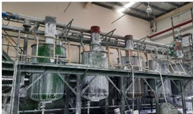
Hình 3. 14: Bồn pha keo và hệ thống xử lý khí thải từ công đoạn pha keo
