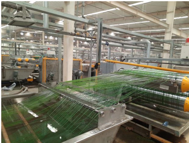
Hình 1. 10: Ngâm nước làm lạnh sợi
