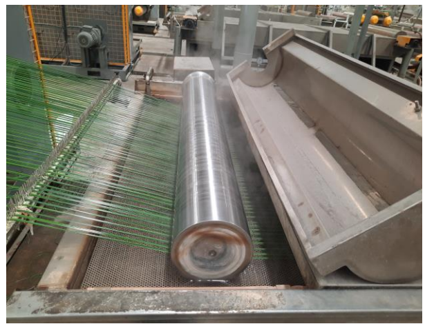
Hình 1. 11: Gia nhiệt bằng nước nóng
