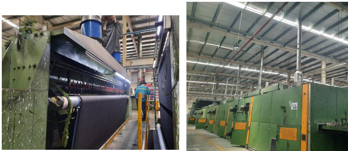
Hình 3. 12: Hệ thống xử lý khí thải từ dây chuyền lên keo và sấy khô thảm cỏ
