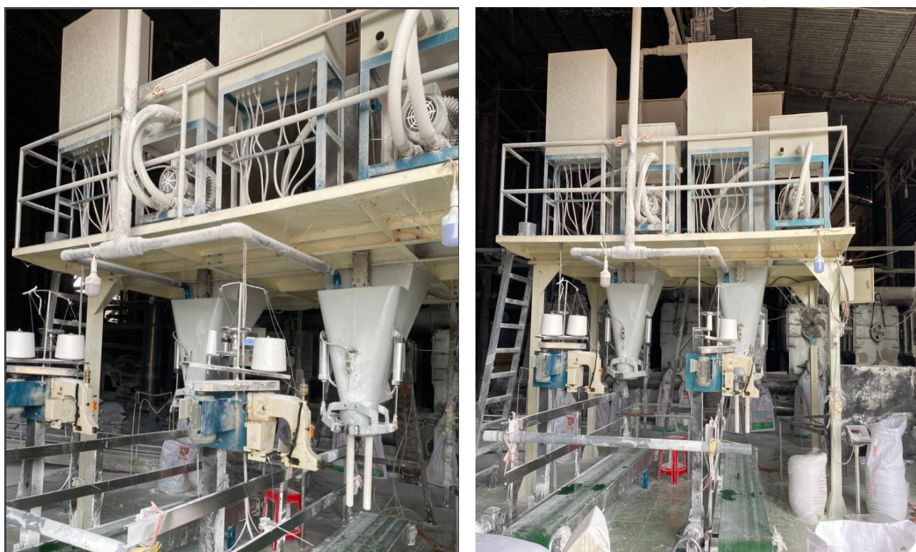
Hình 3.12. Thiết bị đóng bao có trang bị cân định lượng tự động
